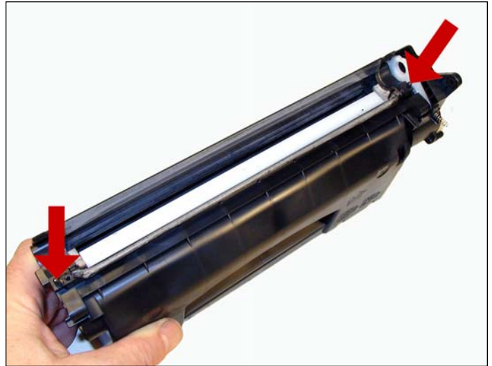
19. Remover los dos tornillos y la cuchilla dosificadora. Levantar el soporte con mucho cuidado de no romper los pequeños postes de alineamiento. Limpiar a fondo cualquier remanente de toner.
