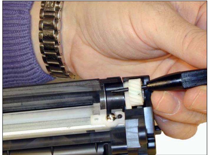
18. Remover el engranaje motriz del rodillo magnético para que no se pierda.
