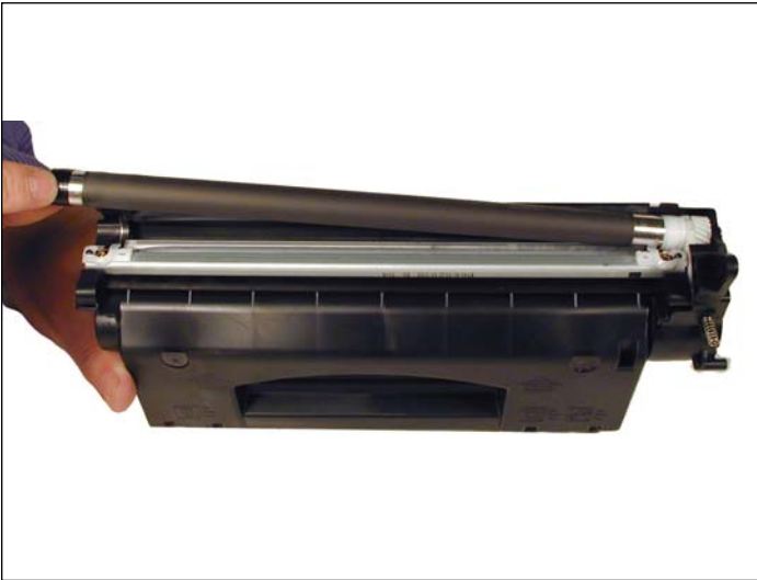
17. Remover el conjunto del rodillo magnético del cartucho.
