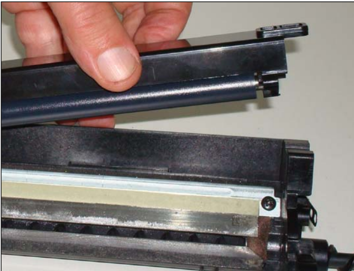
15. Acceso al PCR/Rodillo y Cuchilla de limpieza.
