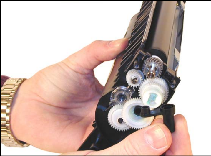
7. Retire el espaciador negro de plástico del eje del rodillo revelador.
