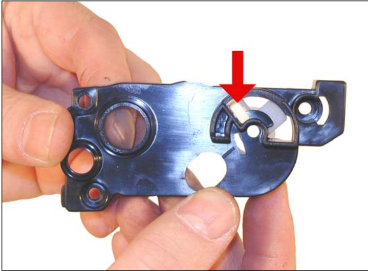
17. Instale el engranaje bandera en la posición indicada, la cubierta y los tres tornillos.
