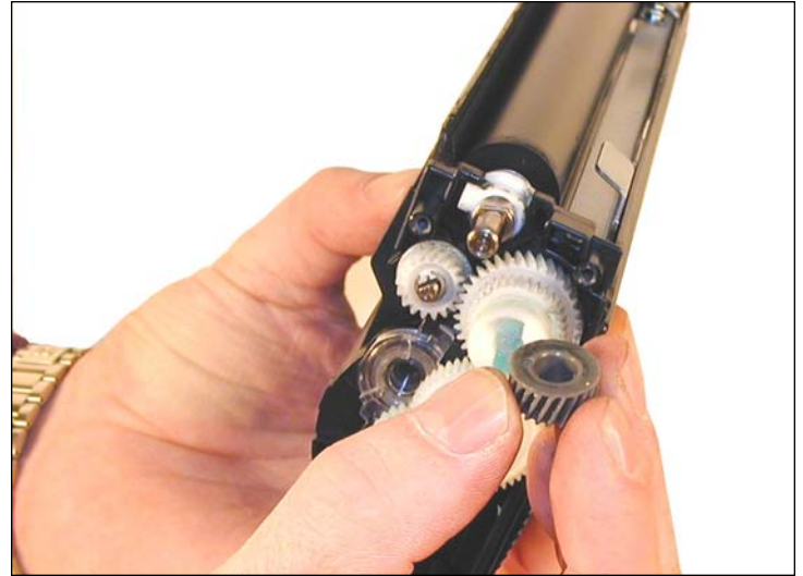
8. Retire el reten tipo "E" y el engranaje pequeño.
